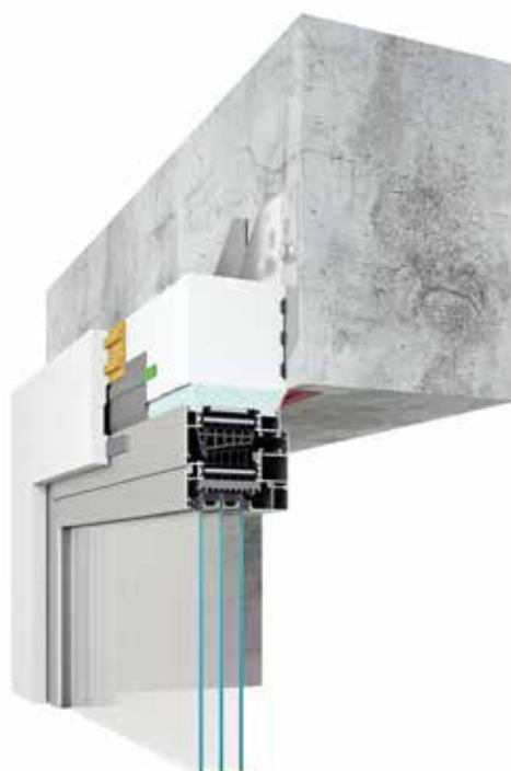
Połączenie górne, z zastosowaniem profilu zewnętrznego węgarka
