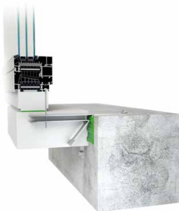
Połączenie dolne, na belce 200 mm z kotwą wewnętrzną
