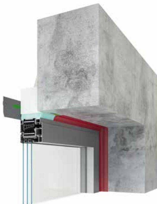
Połączenie górne, z taśmą paroszczelną i klejem-uszczelniaczem
