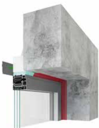
połączenie górne, z taśmą paroszczelną i klejem-uszczelniaczem
