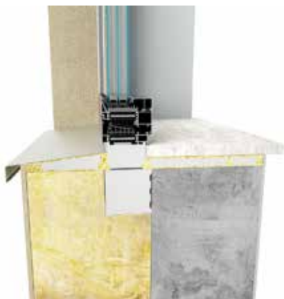
przekrój przez okno zamontowane w warstwie ocieplenia
